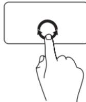
水平スクロールゾーン（タッチパッドの下端）で、時計回りに円を描くように指を動かして右にスクロール、反時計回りに動かして左にスクロールします。
