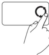
垂直スクロールゾーン（タッチパッドの右端）で、時計回りに円を描くように指を動かしてスクロールアップ、反時計回りに動かしてスクロールダウンします。
